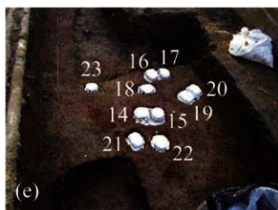
第1図 (a) SC240、(b) SK68、(c) SC374、(d) SK378、(e) SC480 における考古地磁気測定用ブロック状試料採取の様子（試料表面は石膏でコーティングされている） (f) 残留磁化方位測定に用いたキューブ状試片
