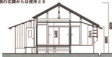
図 4-28 642A 現状断面図 S=1:100
