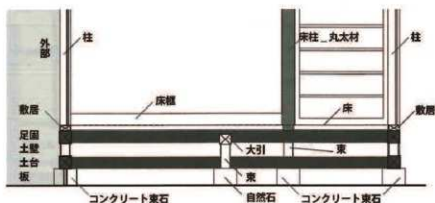
図6-9 64C 床ノ間まわり詳細断面図 S=1/75
