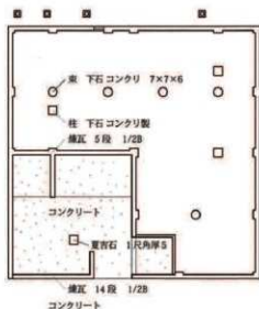
図 6-3 1938 設計基礎図 S=1/100 (「従業員社宅六帖、四帖半二間式新築工事」1938.3.6 をもとに作成)
