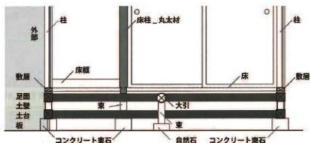
図6-8 64B 床ノ間まわり詳細断面図 S=1/75
