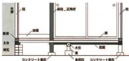
図6-5 64A床ノ間まわり詳細断面図 S=1/75
