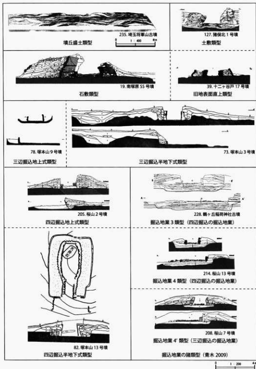
図3 横穴式石室の基礎構造代表例
