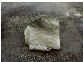
2 橋梁材 2 (黒雲母花崗斑岩+コンクリート)
