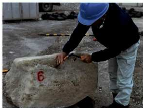
5 橋梁材のサンプル採取状況
