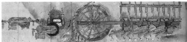
第14図 水車新田（兵庫県神戸市灘区）の絞油水車（「絞油水車器械の図」〔新修神戸市史編集室1986〕）
