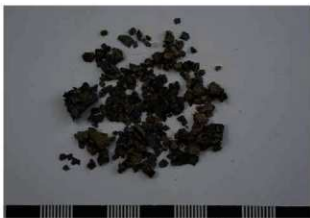
図37 竪穴建物跡 (SB53) 出土鍛造剥片
