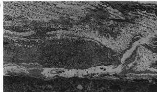
Photo.2 鑄造鉄器、不整長方形鉄片の顕微鏡組織
