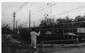
リフトセンサーで空中写真測量
