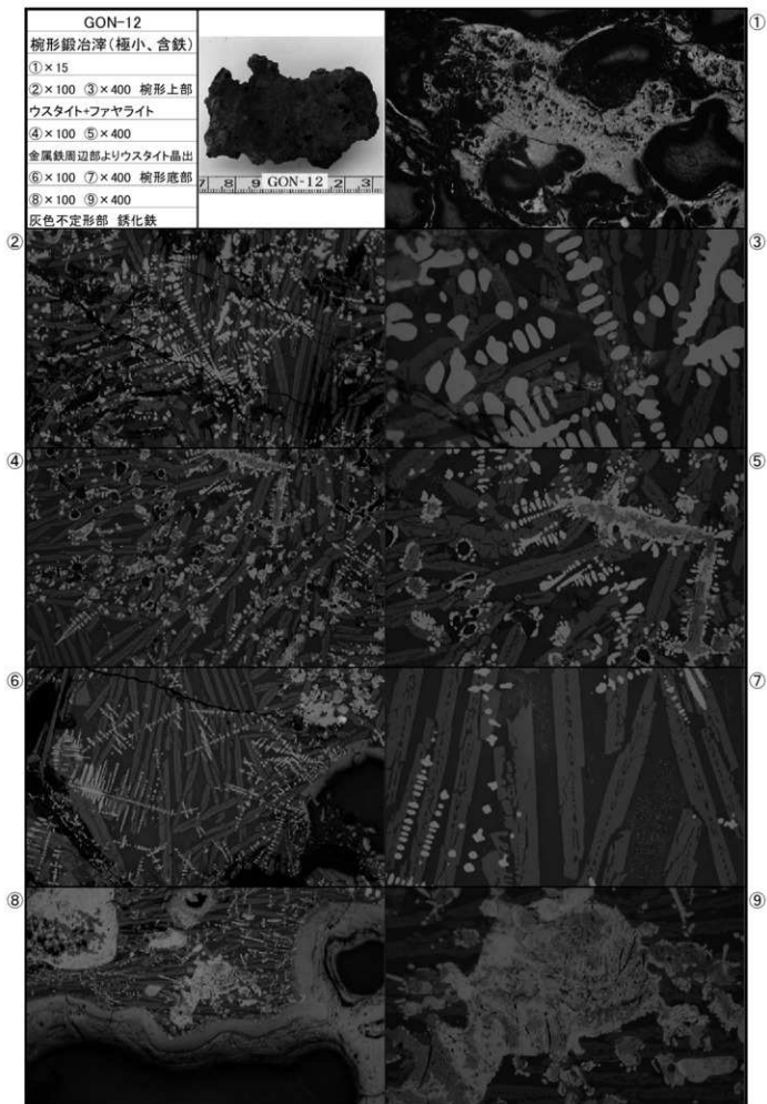
Photo.8 梘形鍛冶滓の顕微鏡写真(杉村遺跡出土)
