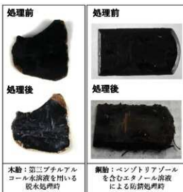
図1 保存処理における漆塗膜の変形
