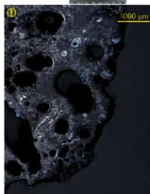
OZO-4 梔形鉄塊系遺物 ④γ相組織 ⑤⑥鉄部拡大 亜共晶組成白鑄鉄組織
