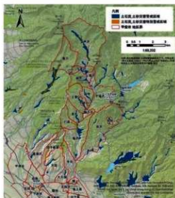
図27 土石流による土砂災害警戒区域 (『甲斐市国土強靱化地域計画』から転載)
