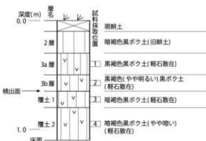
図2. SI-246検出地点の模式柱状図
