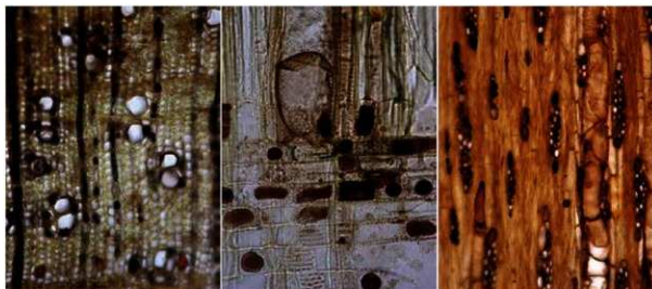
横断面 0.1mm 放射断面 0.1mm 接線断面 0.1mm 7. 掲載番号229 シロダモ属 No.681 建築部材（丸太杭）
