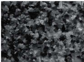
写真2 試料 18 (落射光下. 背景は 1 mm メッシュ) 中央付近に, As-B に由来する淡灰～淡褐色のスポンジ状軽石 型ガラス火山ガラスが複数認められる.
