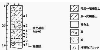
図1 SD07 覆土断面の土層柱状図 ● : テフラ分析試料の層位, 数字 : テフラ分析の試料番号。
