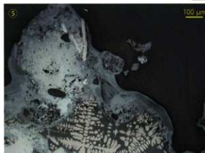
Photo.6 梡形鍛冶滓の顕微鏡組織
