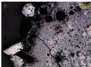
Photo.5 砂鉄焼結塊・流出滓の顕微鏡組織
