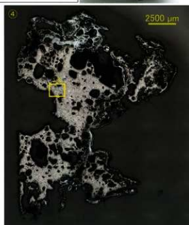
Photo.8 梔形鍛冶滓の顕微鏡組織
