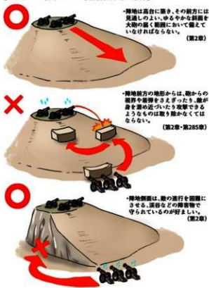
図44. サヴァール教本にみる砲戦優位陣地構築の際の条件(左)と、それと「野崎の丘」における戸切地陣屋の防衛構造との比較(右)
