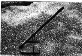
⑪ ジョレン(城) 盛った土を動かすのに使う。刃幅25寸、柄の長さ90寸。
