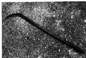
⑥ ヤマハライナタ(城) 杉山の下払いに用いる。刃の長さ24寸、柄の長さ89寸。
