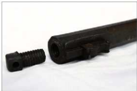
八板金兵衛清定が製作に苦勞した銃ねじ（右）
