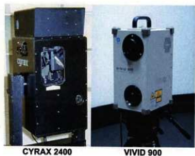
図 1: フゴッベ洞窟の三次元計測に用いられたセンサー。
