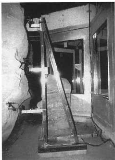
写真4. 架台付の変位計
