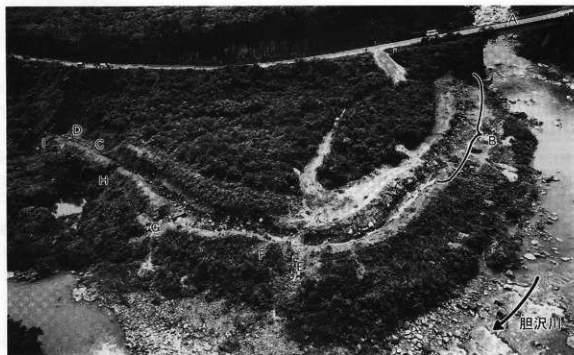
A：馬留橋 B：風化部分（約100m） C：昭和穴（昭和2～3年） D：七右衛門穴 E～H：余水吐 I：余水吐及び水門
