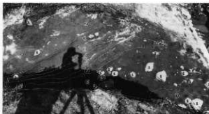
断面2 (河川部・立派部②-2付記) 1層 10YR2/2 ・黒褐色 ・細まり ・疎 ・粘性なし ・腐食土 2層 × 4/2 ・灰黄褐色 × ・密 × 3層 × 4/2 ・黄褐色 × × ・砂質シルト 4層 × 5/2 ・灰黄褐色 × ・やや疎 × 5層 × 4/2 ・黄褐色 × ・疎 × 6層 × 4/2 ・黄褐色 × × ・砂質シルト 7層 × 4/2 ・黄褐色 × × × 8層 × 4/3 × × × ・(細中密) 9層 × 3/2 ・黒褐色 × × ・砂 (細大粒) ※9層より下は、石瓦断面管質の山体基盤岩となっている。
