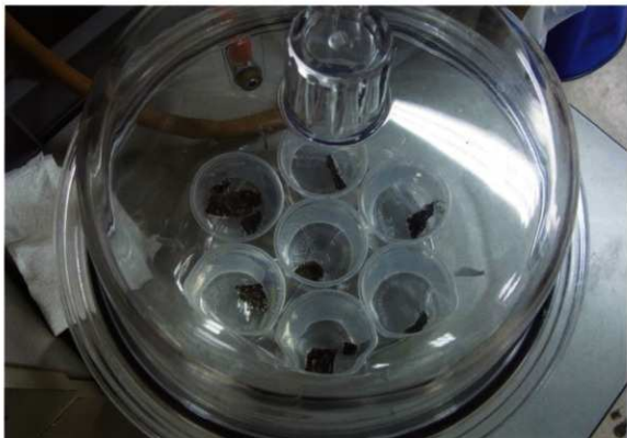
含水率の測定（蒸留水による含水）
