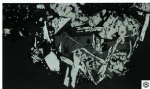
Photo. 3 再結合滓の顕微鏡組織
