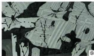
Photo. 3 再結合滓の顕微鏡組織
