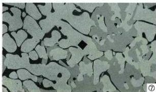
Photo. 2 梘形鍛冶滓の顕微鏡組織
