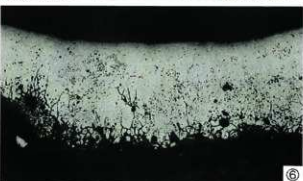
Photo.7 粒状滓・鍛造剥片の顕微鏡組織
