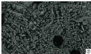
Photo. 6 粒状滓の顕微鏡組織
