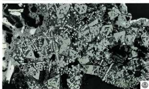
Photo.5 再結合滓の顕微鏡組織
