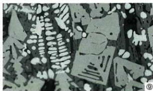
Photo.5 再結合滓の顕微鏡組織
