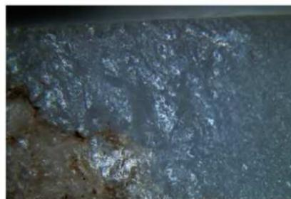
3. 実体顕微鏡 破断面
