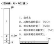
図20 土層柱状図 (西外構) (縮尺1/40)
