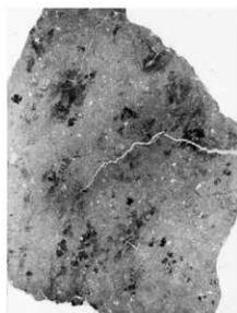
1 中世層試料の薄片スキャン像（横2.5cm） 酸化鉄の沈着が多い部分が不均質に分布する。
