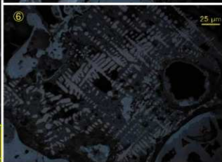
第 44 図 鍛冶滓の顕微鏡組織
