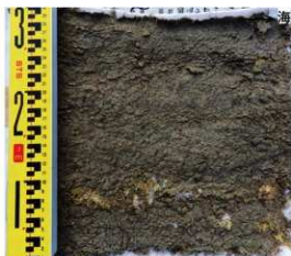
③剥ぎ取り標本 スプレー式接着剤を使用した土層剥ぎ取り法(戸倉1996)によって実施した。5～10cm付近の黄褐色層が腐植物層である。
