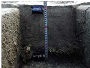
④珪藻分析用試料採取 U字溝最上部(sampleA)と腐植物層下の最下部(sampleB)から、土層構造を崩さずに、ブロックサンプリングを行った。
