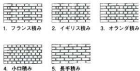
図2 れんがの積み方 (横浜開港資料館『日本の赤煉瓦 1851-1923』より)
