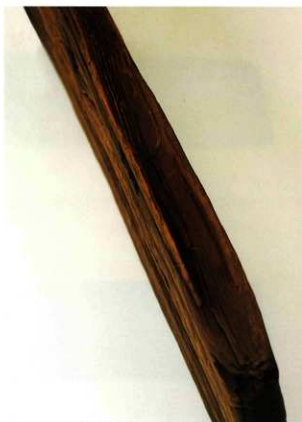
4 桶部倉矧壁板 側面部V字谷形加工
