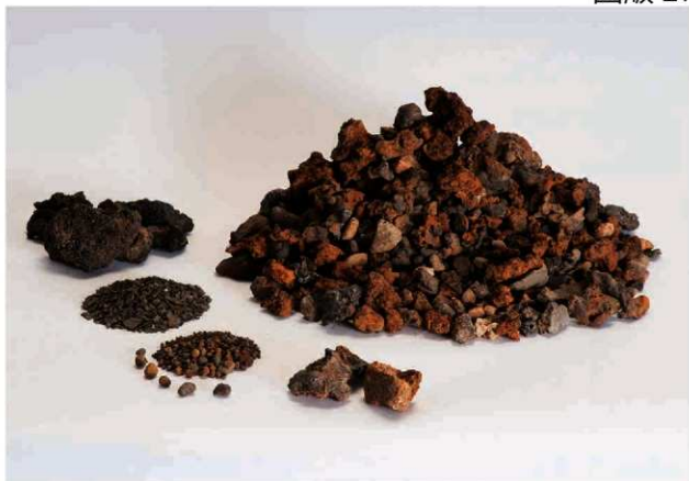
(1) S K 48 出土铁滓·羽口·粒状滓·鍛造剥片·石炭
