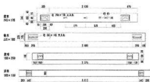
第32図 冠木及び敷桁痕跡
