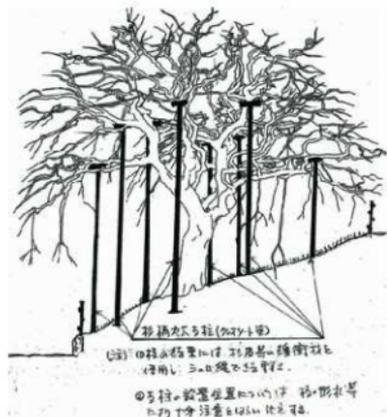
降雪による枝折れ防止を目的に杉丸太類支柱(クレオソート塗布材)を8か所設置
