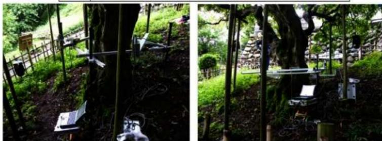
γ線樹木腐朽診断器による調査状況
