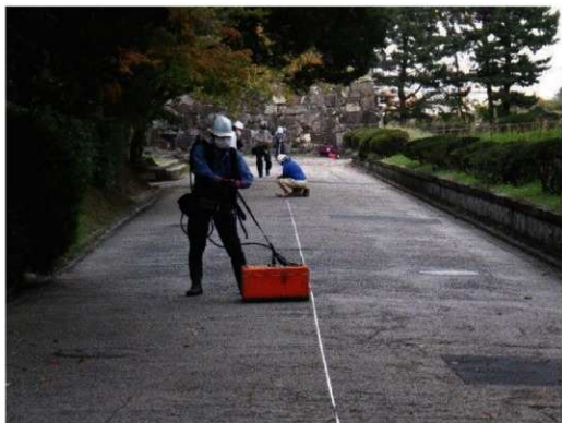
地中レーダー探査の様子
