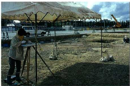
図面作成作業の状況② 平板実測にて道跡の平面図 を作成する。
