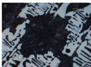
Photo 10 鉄塊系遺物の顕微鏡組織
