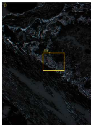
Photo 5 再結合滓の顕微鏡組織
