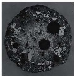
Pl.11 上段：鉄鉱石（風化：褐鉄鉱主体）(HYK-4) のマクロ組織 下段：粒状滓様遺物 (HYK-11) のマクロ組織 (×20)
