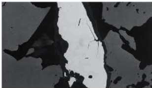
PI.1 炉壁・鉄鉱石の顕微鏡組織
