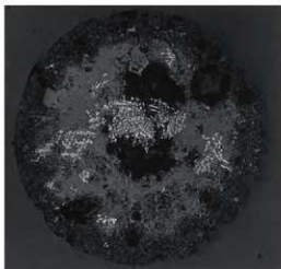
Pl.11 上段：鉄鉱石（風化：褐鉄鉱主体）(HYK-4) のマクロ組織 下段：粒状滓様遺物 (HYK-11) のマクロ組織 (×20)
