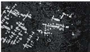
Pl.8 炉内滓・流出孔滓・粒状滓様遺物の顕微鏡組織
