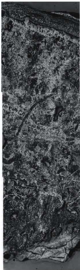
PI.4 鉄鉱石の顕微鏡組織
