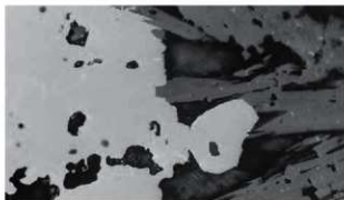
PI.3 磁鉄鉱の顕微鏡組織
