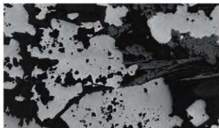
PI.3 磁鉄鉱の顕微鏡組織
