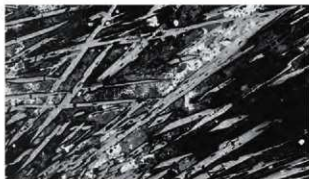
Pl. 10 鉄塊系遺物・青銅塊の顕微鏡組織
