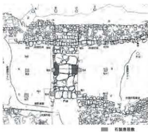
図4-4 石製唐居敷が用いられた城門例 岡山県総社市 鬼ノ城西門平面図 (S=1/300) ● 意味に記す参考文献から引用、一部加筆。
