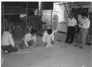
35. 原寸検査：墨打ち (同上)
