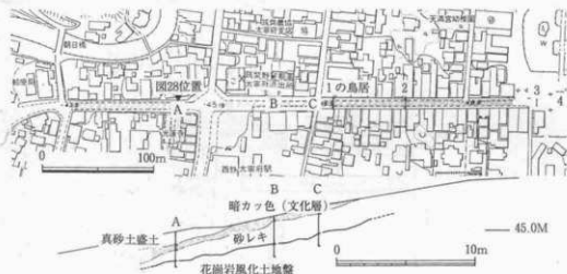
第27図 参道地盤土層模式図 (距離:高さ=1:2.5)
