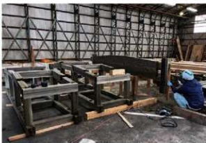
第115図 防腐剤を含浸処理した天秤ふいこの部材 (左) と組み立て状況 (右) (令和4年度)
