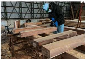
第114図 天秤ふいこの部材 (左:スギ材) と加工状況 (右) (令和4年度)
