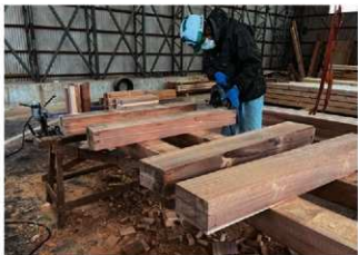
天秤ふいご復元製作状況（1）（部材加工状況）
