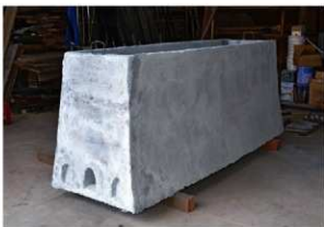
第112図 製鉄炉の製作状況 (左:メタルス下地 右:モルタル塗り) (令和4年度)
