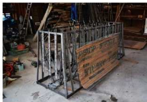
第112図 製鉄炉の製作状況 (左:メタルス下地 右:モルタル塗り) (令和4年度)
