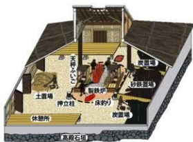
第68図 越堂鉦の高殿内部の復元
