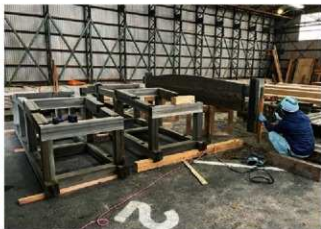
天秤ふいご復元製作状況（2）（部材組み立て状況）
