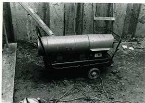
③ ジェットヒーターの全景
