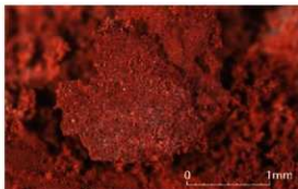
10. 同拡大(20倍) 赤玉の中には暗赤色の酸化鉄小塊も認められるが、小塊内には夾雑物として赤色以外も鉱物が多数認められる。
