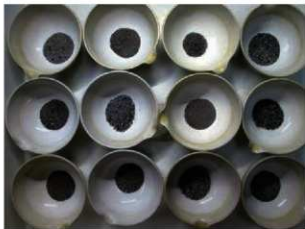
写真133 洗浄・乾燥後のテフラ検出分析試料(1) 蒸発皿上面の直径は90mm
