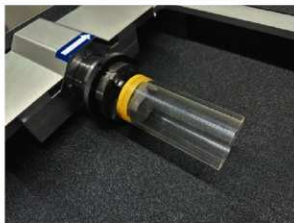
図11 CT撮影用プレートと付属品、筒型付属品の取付状況
