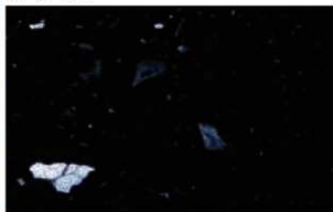
48.024 内間 報文番号262 6区 SD093 弥生土器 鉢 基質 Qz:石英.PI:斜長石.P-Qz:多結晶石英.Gra:花崗岩.Vg:火山ガラス. P:孔隙.写真左列は下方ポーラー、写真右列は直交ポーラー下。
