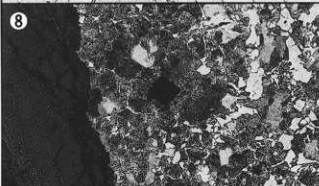
Photo.12 鉄斧の顕微鏡組織
