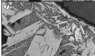
Photo.4 椀形鍛冶滓の顕微鏡組織
