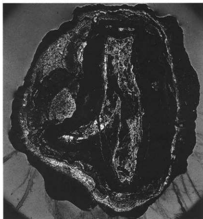
Photo.14 上段:鉄斧刃先(SMT-3) のマクロ組織(×10) 下段:鉄製品(SMT-17) のマクロ組織(×5)
