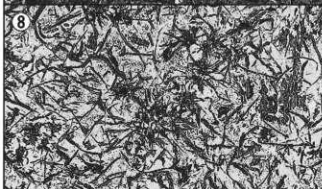
Photo.13 鉄製品の顕微鏡組織
