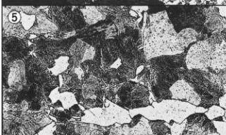
Photo.10 鉄斧の顕微鏡組織
