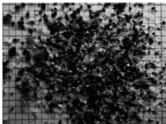
写真2 旧石器トレンチ8 東壁・試料9(落射光) felsic鉱物や斜方輝石および単斜輝石のほかに、無色透明や淡灰色の中間型ガラスが含まれている。背後は1mmメッシュ。
